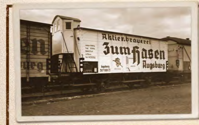
Güterwaggons wie diese sorgten dafür, dass auch Bierliebhaber außerhalb Augsburgs in den Genuss der guten Hasen-Biere kamen. Zur Kühlung der Biere während des Transports wurde zumeist Stangeneis verwendet.
